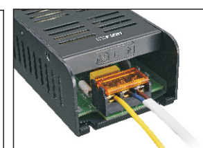
(图6) 输入端接市电安装方式
